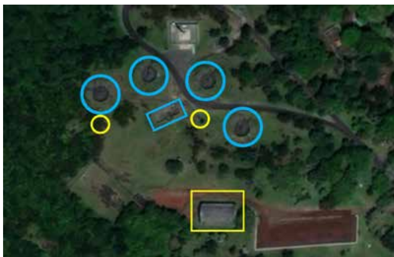
Fig. 7 – Imagem de satélite da Bateria de Artilharia Antiaérea, no Pico das Cruzinhas do Monte Brasil. Nela são visíveis os quatro espaldões onde se encontram posicionadas as peças de artilharia (círculos azuis) bem como o Posto de Comando de Tiro (rectângulo azul), dois espaldões para metralhadora pesada (círculos amarelos) e paiol (rectângulo amarelo). Adaptado de imagem obtida do Centro de Informação Geoespacial do Exército ( http://www.igeoe.pt/cigeoesig/ ).
