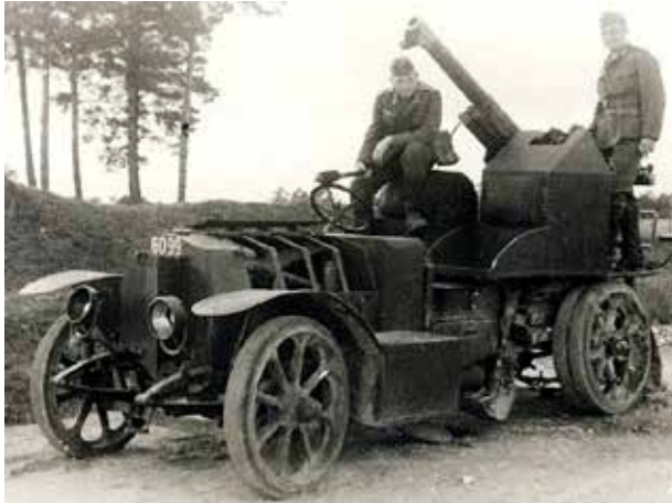
Fig. 1b - Canhão antiaéreo francês, de 75 mm modelo 1913, montado em viatura automóvel, capturado por foças da Wehrmacht, em 1940. Claramente uma evolução da peça de campanha de tiro rápido 75 mm. Imagem de fotógrafo desconhecido. Wikicommons
