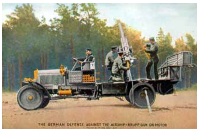
Fig. 1a - Canhão antiaéreo alemão 77mm (Krupp), montado em viatura automóvel, durante a grande Guerra. Imagem colorida de fotógrafo desconhecido. Wikicommons
