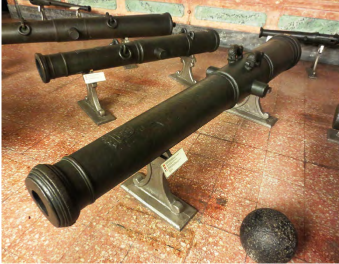
Fig. 8 – Em primeiro plano um Canhão (Espera) em bronze com 12,4 cm (calibre) que disparava balas em ferro de 6 kg. Em segundo plano um Pedreiro (Camelete) em bronze com 17,3 cm (calibre) que disparava pelouros em pedra de 5.5 kg. (Museu Militar de Lisboa).
